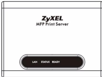
Die **LAN**-LED leuchtet, wenn der **LAN**-Anschluss richtig verbunden ist, und sie blinkt, wenn Daten empfangen oder gesendet werden.
