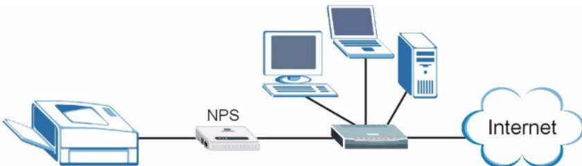
Über den NPS-520 arbeitet der Drucker, als wäre er direkt an dem Computer angeschlossen.
