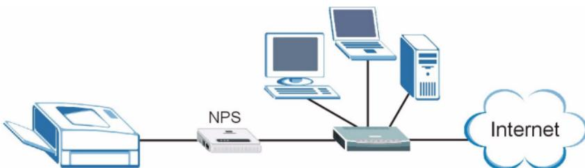
При использовании NPS-520 принтер работает так, как будто он напрямую подключен к компьютеру.
